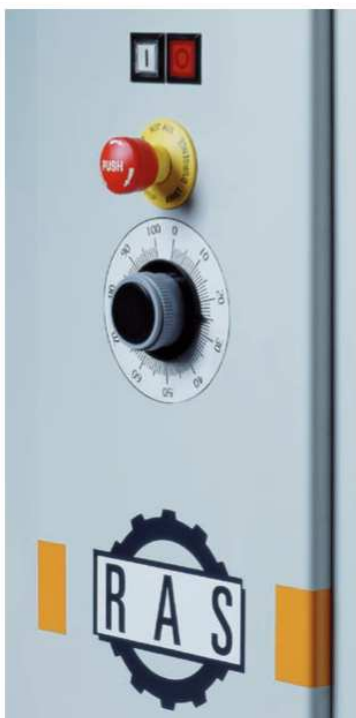
Arbeitsgeschwindigkeiten variabel 0 – 9,4 m/min
