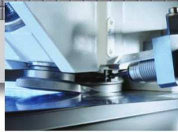
Automatische Blechführung für Bordhöhen von 8 oder 10 mm (Option)
