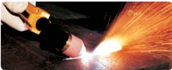
Plasmafugen mit dem Handbrenner PB-S45 WH
